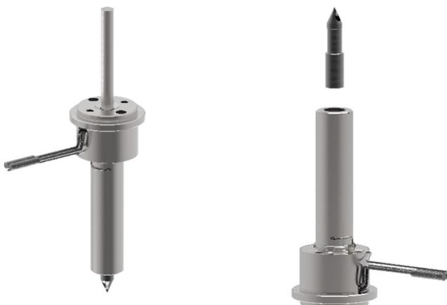
**Falls die Düsenspitze nicht mit herausgedreht wird, muss diese mithilfe eines Dornes von hinten herausgeschlagen werden. Die Düse sollte hierbei ebenfalls auf Betriebstemperatur sein.**
