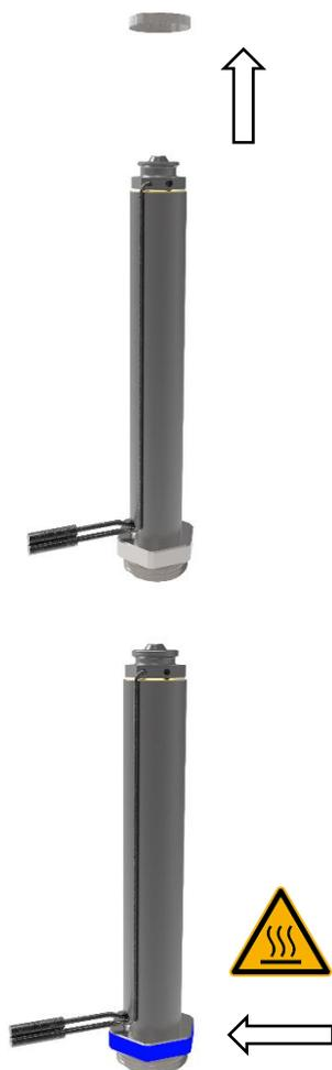
**Entfernen Sie die Fühlerhalterung und spannen Sie die Düse am Kopf des Materialrohres mit Schonbacken in einen Schraubstock ein.**
