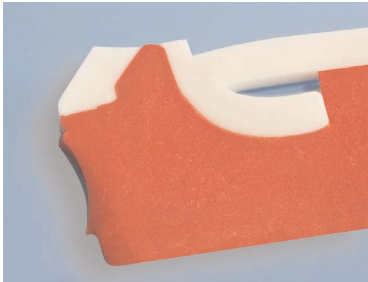
Schnittbild einer Endkappe, die Anzahl der eingeschlossenen Gasbläschen nimmt nach außen zur Artikeloberfläche stark ab
